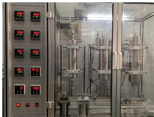
图 6 岩芯孔隙率-渗透率一体化测试装置
